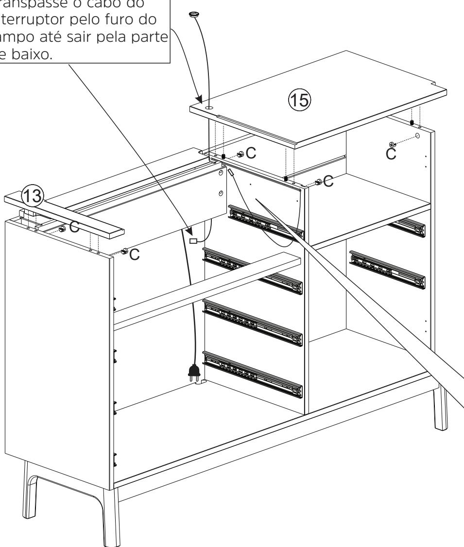
Passe o conector pelo recorte e até sair pela parte de baixo em seguida coloque - o dentro do canal.
