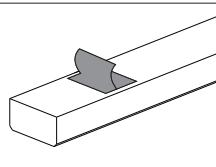
Remova as proteções das fitas e cole o led conforme a figura abaixo.
