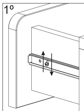
Solte um pouco o parafuso ate que consiga mexer a gaveta, ajuste a altura apertando-o em seguida.
