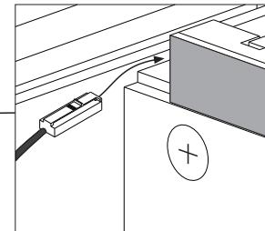
Antes de colar a barra de led passar o conector pelo recorte até sair pela parte de baixo.
