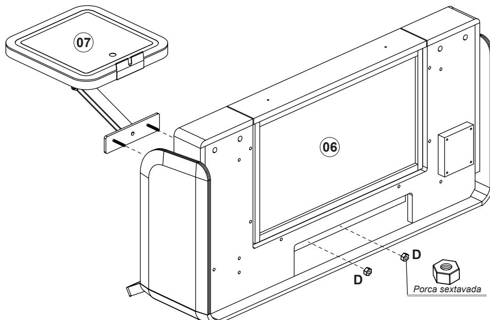
Após a fixação do suporte de espelho (7) com as porcas sextavadas (D) na caixaria (6) deve-se realizar a ligação das tomadas e leds. Os plugues são por meio de conectores rápidos de fácil manuseio, sendo no total 3 plugues abaixo da fixação do espelho e o último plugue no rodapé da estrutura. Próximo passo fixação da estrutura e tampa de acabamento para instalação elétrica.
