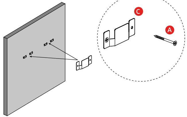
Fixe o Suporte (C) Utilizando o Parafuso (A).
