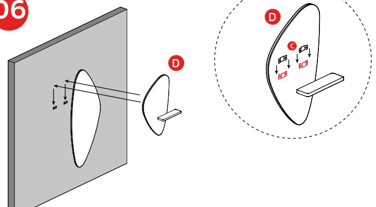
**Encaixe o Espelho (E) no suporte (C) na parede de cima para baixo.**
